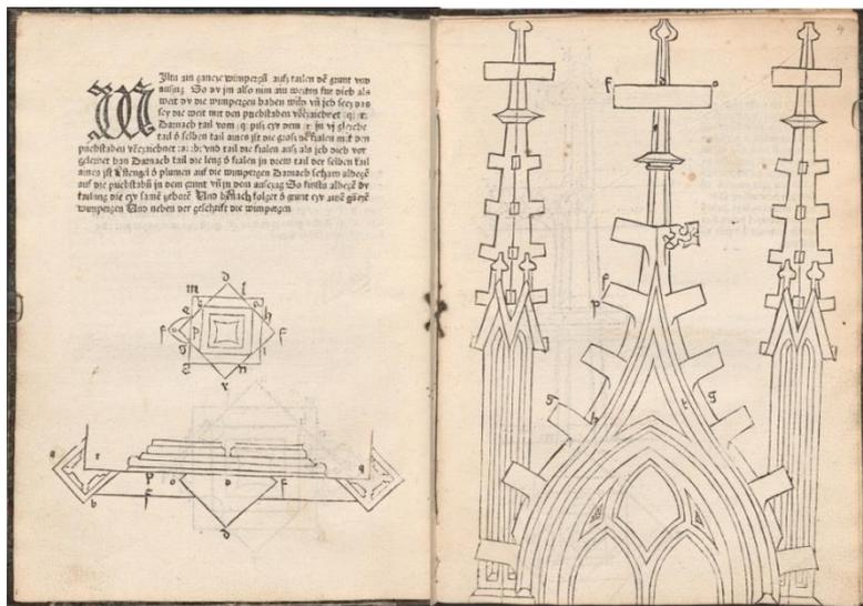
Fig. 10. Construcción geométrica de un gablete, en la *Geometria deutsch* de Roriczer, fol. 6. (N. del T.: En realidad es el fol. 2 del “Opúsculo sobre los Gabletes”).
