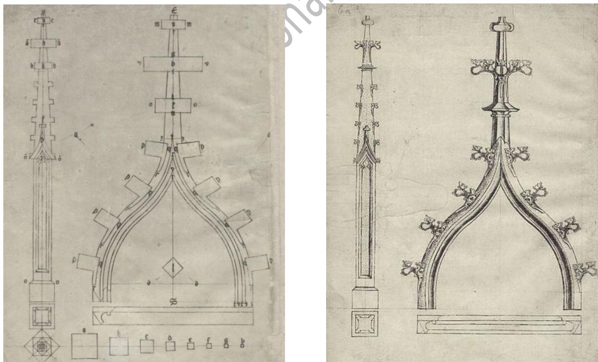
Figs. 8 y 9. Construcción geométrica (izda.) y ejecución arquitectónica (dcha.) de un pináculo y un gablete, en el *Fialenbüchlein* de Schmuttermayer, fol.1, v y 6, v.
