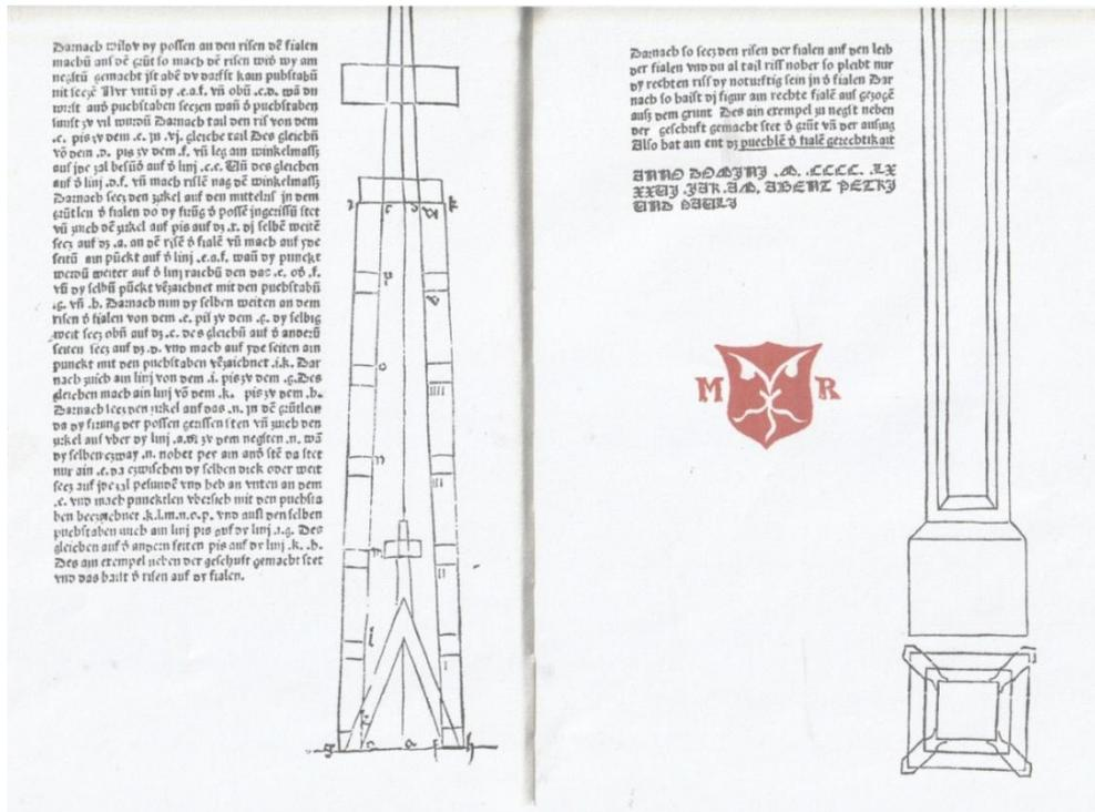
Fig. 7. Replanteo del alzado de un pináculo, del *Büchlein von der Fialen Gerechtigkeit* de Roriczer, fols. 9v-10r.
