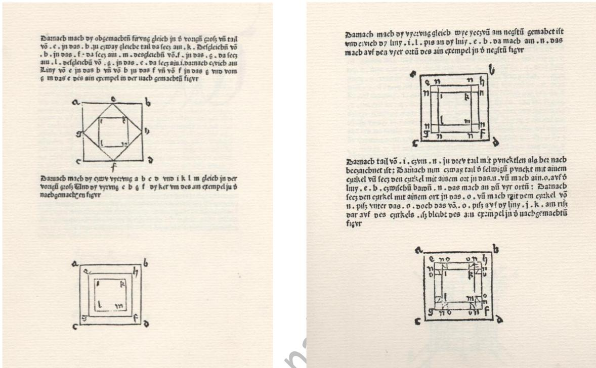
Fig. 6. Replanteo de la planta de un pináculo, del *Büchlein von der Fialen Gerechtigkeit* de Roriczer, fols. 3v-4r.
