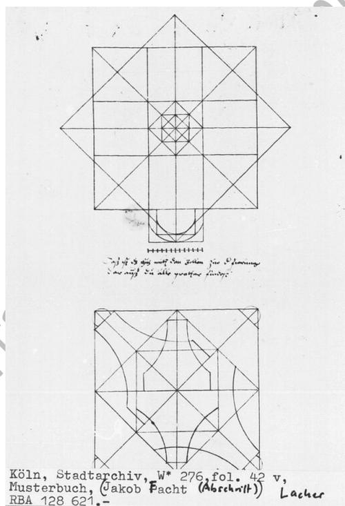
Fig. 11. Construcción geométrica de una plantilla para el parteluz de una ventana, en las “Enseñanzas” de Lechler. Archivo Histórico de Colonia, ms. Wf 276, fol. 42, v.
